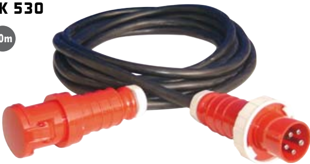
Cable de corriente de 5 conductores para líneas trifásicas con conectores CEE (3P + N + E) de entrada y salida. Capacidad 63A. Longitud 10m.
