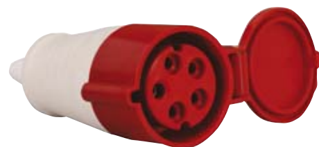
Conector trifásico CEE (Hembra). 5 polos. 16 Amperios. (3p + N + T)
