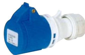
Conector monofásico CEE (Hembra). 3 polos. 32 Amperios. (1p + N + T)
