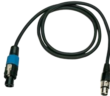
XLN 4(Macho)-XLR 3(Hembra). Para Altavoces, cable de 10 m. (2 x 2,5 mm).
