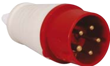
Conector trifásico CEE (Macho). 5 polos. 16 Amperios. (3p + N + T)
