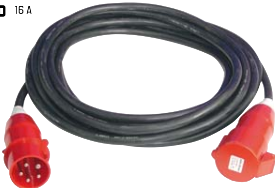
Cable de corriente de 5 conductores para líneas trifásicas con conectores CEE (3P + N + E) de entrada y salida. Longitud 10m.
