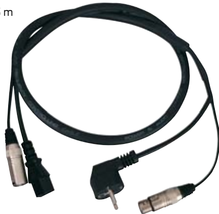
XLR de 3 Contactos Macho + IEC Hembra. XLR de 3 Contactos Hembra + IEC Macho. Cable con 2 conductores independientes, uno de señal de audio y otro de alimentación. Especialmente indicado para cajas autoamplificadas.
